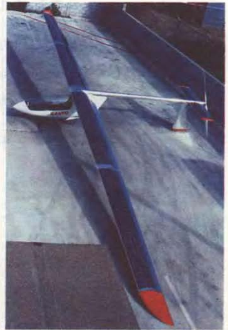
САМОЛЕТ компании Sanyo, приводимый в движение легкими гибкими солнечными батареями.
