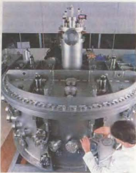
СИНХРОТРОН, генерирующий рентгеновское излучение для производства интегральных микросхем, сооружается в настоящее время фирмой Oxford Instruments для IBM.
